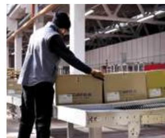
**Peso e volume vengono verificati** per controllare la conformità rispetto ai dati teorici e riportati sulla etichetta. In caso di difformità, il cartone viene scartato e ricontrollato.
